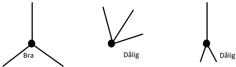
Figur 2.2.1.a. Exempel på bra och dålig konfiguration av utgångspunkter vid stationsetablering i plan.
